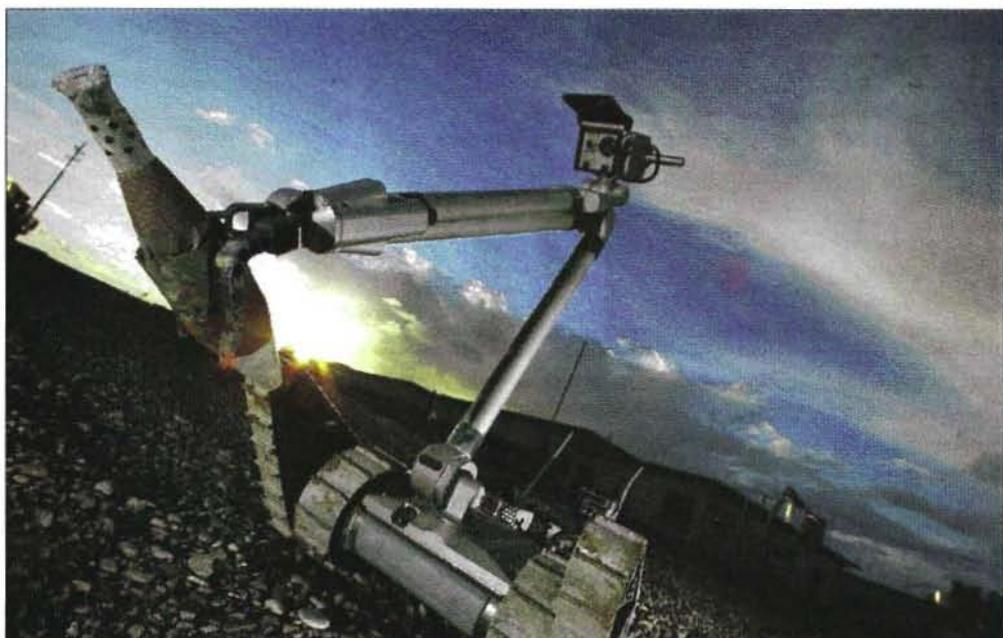
*Наземные дистанционно управляемые аппараты широко применяются коалиционными силами в Афганистане для обезвреживания мин, самодельных взрывных устройств и неразорвавшихся боеприпасов*
