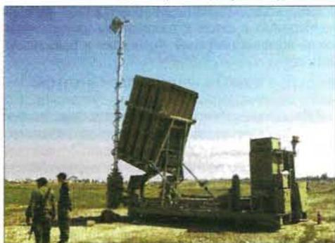
обстрелам из Сектора Газа. Этот комплекс предназначен для перехвата в первую очередь ракет класса «земля — земля» с дальностью стрельбы от 4 до 40 км. При этом ракета-перехватчик (ее заявленная стоимость 50 тыс. долларов) выстреливается комплексом только в том случае, если расчетное место падения ракеты противника приходится на населенный пункт или другие защищаемые объекты.
